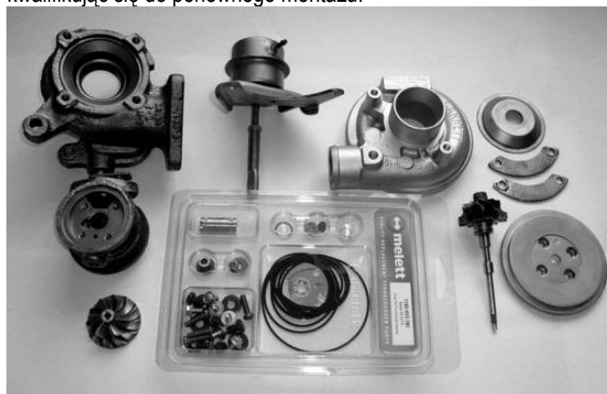
Rys. 4. Widok zestawu naprawczego do turbosprężarki firmy Melett oraz elementów zakwalifikowanych do ponownego montażu
