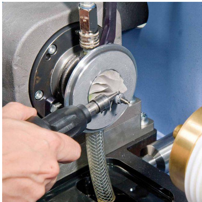
Rys. 6. Widok usuwania masy z nakrętki koła kompresji celem wyrównoważenia układu wirującego
