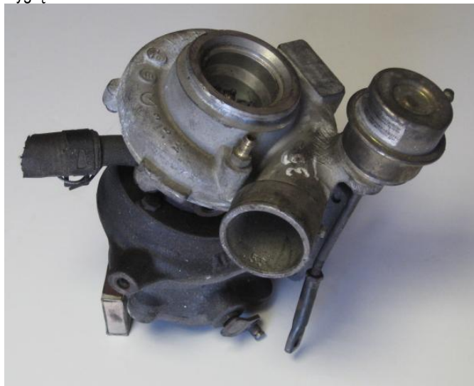
Rys. 1. Widok uszkodzonej turbosprężarki
