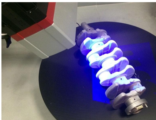
Rys. 3. Proces skanowania geometrii wału.
