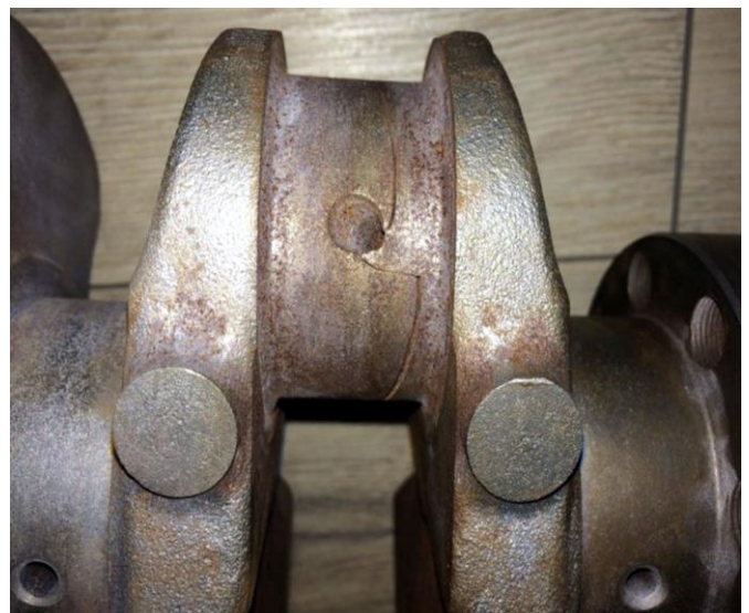
Rys. 2. Pęknięcie eksploatacyjne wału na powierzchni czopa korbowego nr 4
