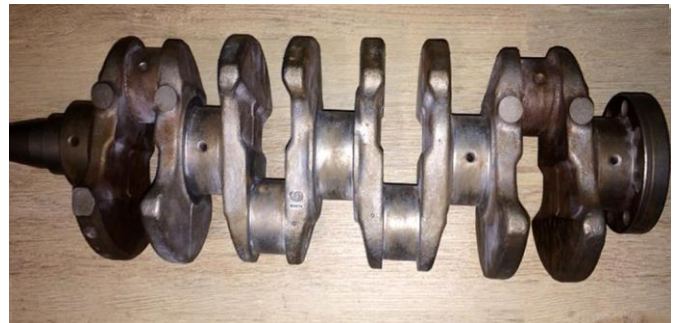
Rys. 1. Wał korbowy silnika z zapłonem samoczynnym, będący przedmiotem analizy
