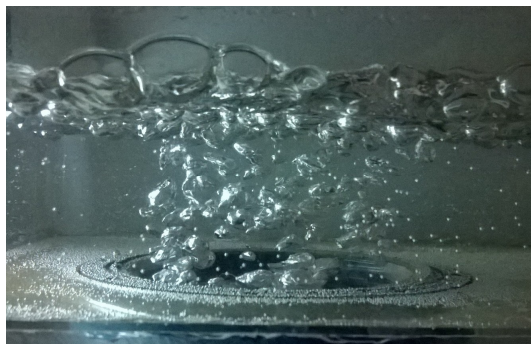
Rys. 2. Odgazowanie fazy ciekłej w strefie (4) na stanowisku badawczym w Katedrze Inżynierii Chemicznej i Procesowej Politechniki Krakowskiej
