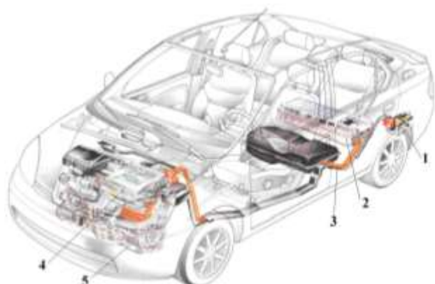
Rys. 4. Rozmieszczenie elementów napędu hybrydowego w samochodzie: 1 – akumulator 12 V (ołowiowy), 2 – akumulator hybrydowego zespołu napędowego, 3 – przewody wysokiego napięcia (kolor pomarańczowy), 4 – falownik, 5 – silnik elektryczny.
