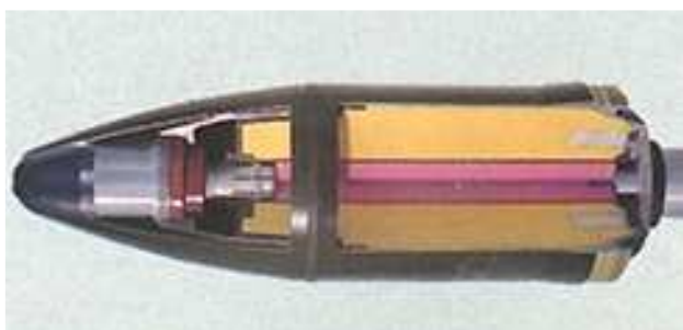
Rysunek 10. Przekrój głowicy termobarycznej kierowanego pocisku rakietowego 9M114F (z lewej)
