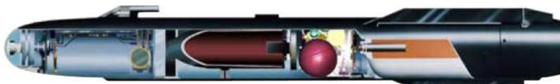
Rysunek 7. Przekrój pocisku raketowego HELLFIRE AGM-114N
