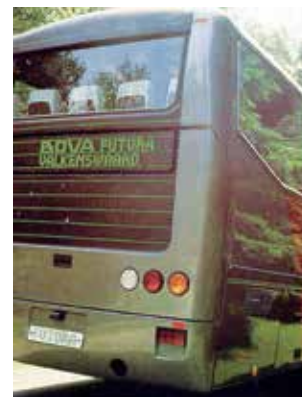
W pierwszej generacji Futury pokrywa silnika zachodziła na boki nadwozia, a tylna szyba była osadzona głęboko pod obrysem spojlera
