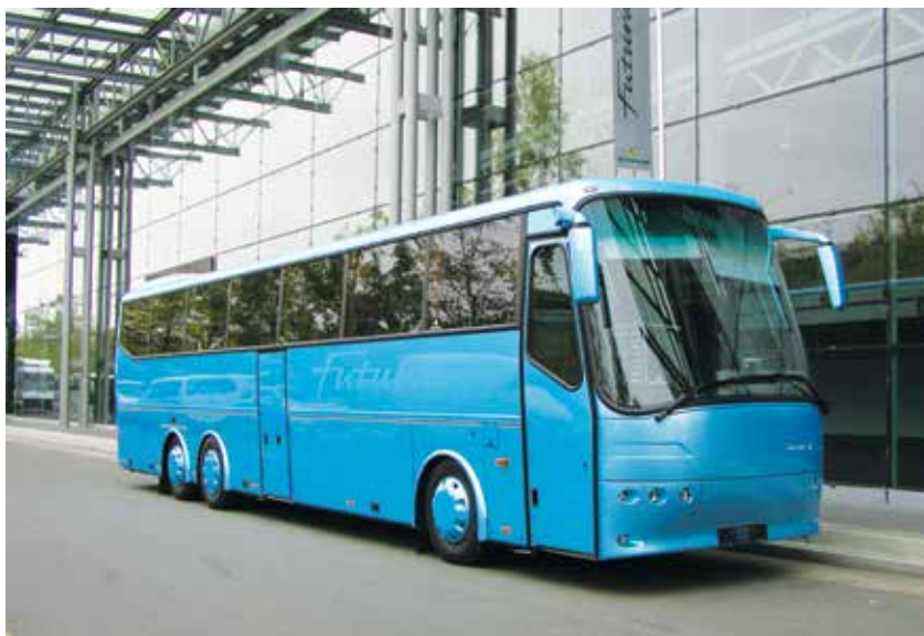
Trzyosiowa odmiana Futury FH14 z frontową ścianą wyposażoną w indywidualne reflektory punktowe. Tę odmianę nadwozia produkowano w latach 1999–2006
