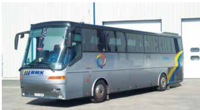
Bova Futura FH12 z połowy lat 90. ubiegłego stulecia. Uwagę przykuwa nową kształt lusterek oraz powiększone kierunkowskazy, wkomponowane w przetłoczenie przedniego podszycia
