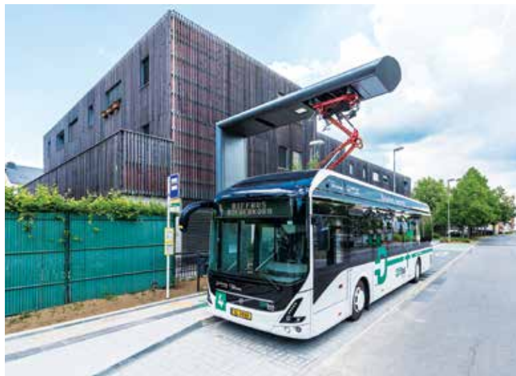
Volvo 7900 Electric w Differdange (Luksemburg) na stacji ładowania energii. Fot. Volvo
