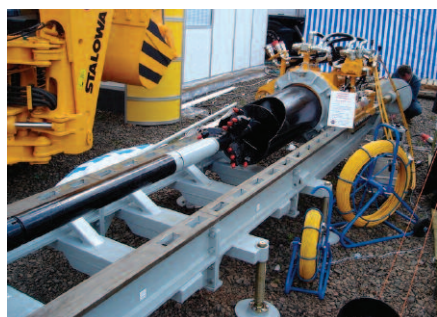
Fot. 1. Przykładowe urządzenie do poziomego przewiertu sterowanego – widoczna żerdź pilotowa, pierwsza stalowa rura osłonowa z przenośnikiem ślimakowym i wiertnica zamontowana na torowisku Fot. autor
