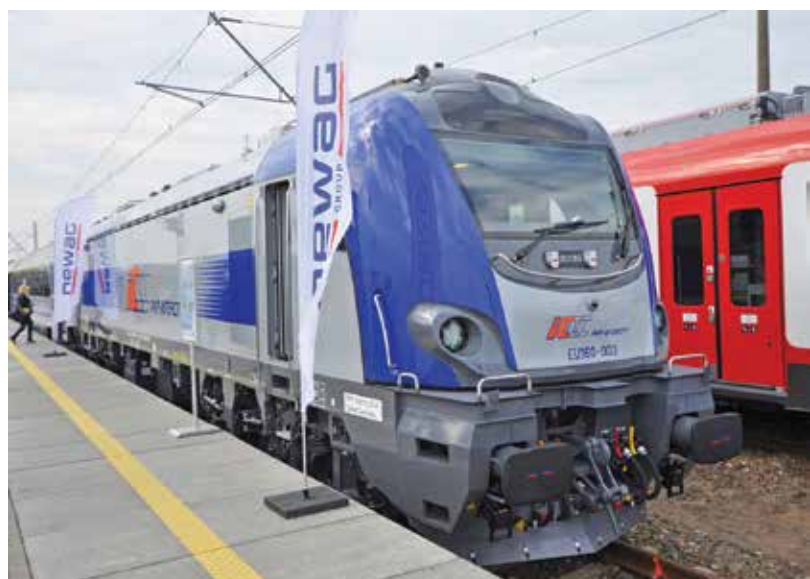
Lokomotywa Griffin serii EU160-003 (producent - Newag) dla PKP IC
