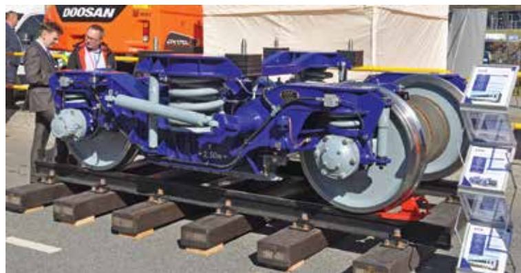
Wózek typu 25AN4 (producent - FPS Poznań)
