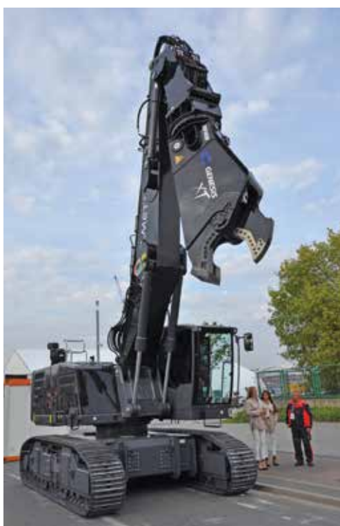
Ciężki pojazd gaśnicowy serii GXT 445R (producent - Genesis) przeznaczony do likwidowania katastrof, w tym cięcia blach metalowych o znacznej grubości
