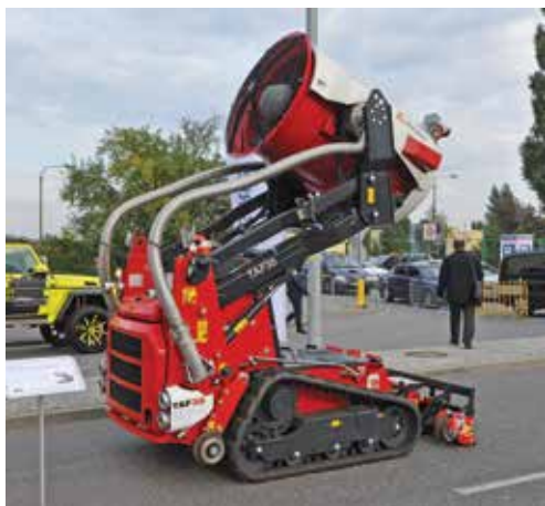
Samojezdna turbina gaśnicza serii TAF35 (producent - Magirus) przeznaczona do wentylacji i gaszenia pożarów w tunelach, dworcach, itp
