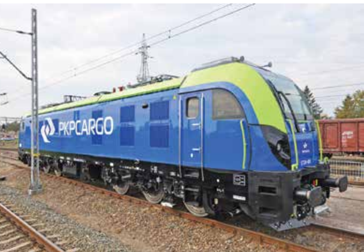
Lokomotywa Dragon 2 serii ET26-001 (producent - Newag) dla PKP Cargo
