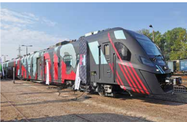
Hybrydowy zespół trakcyjny Impuls serii 36WEh-001 (producent - Newag)
