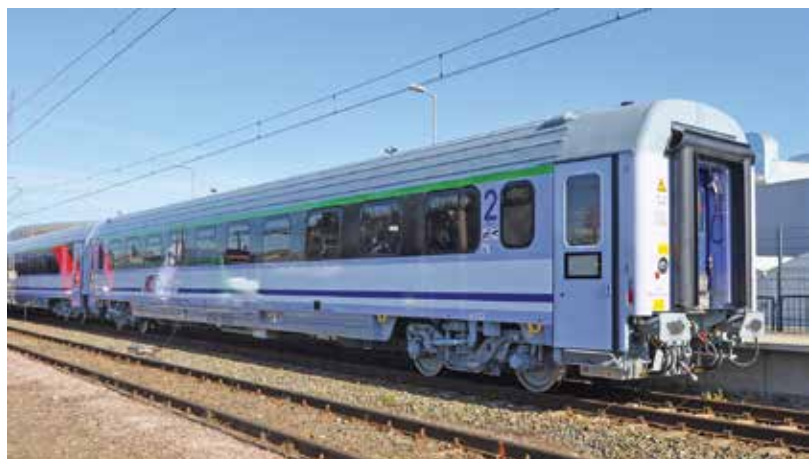
Zmodernizowany wagon typu 174A (ex-111A) z wózkami typu 25AN4 (modernizacja - FPS Poznań) należący do PKP IC
