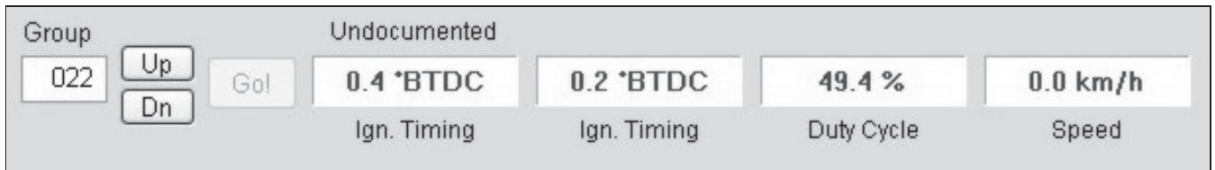
Rys. 7. Grupa wskaźnik zawierająca informację o szybkości pojazdu (VW Golf IV 1,9 TDI) Źródło: Opracowanie własne.
