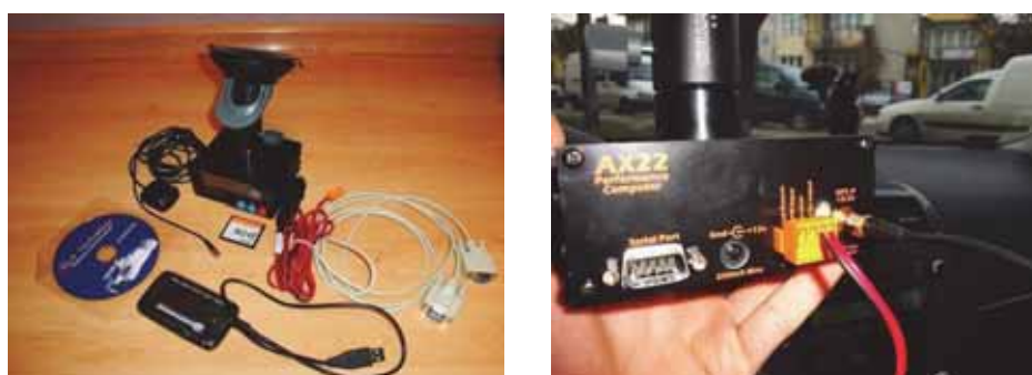
Rys. 3. Elementy urządzenia pomiarowego AX22 firmy Race-Technology Źródło: Opracowanie własne.
