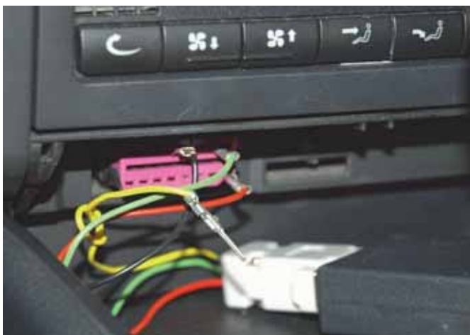
Rys. 8. Złącze diagnostyczne OBD II/EOBD wykorzystywane w badaniach (VW Golf IV 1,9 TDI) Źródło: Opracowanie własne.
