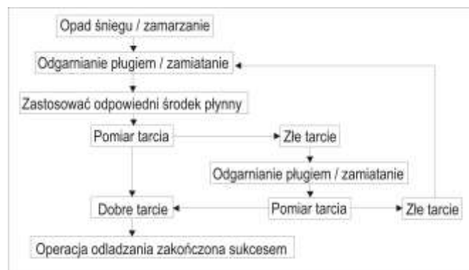
Rys. 3. Schemat postępowania podczas odladzania przy użyciu środka chemicznego
