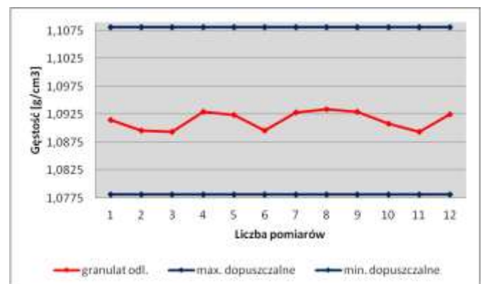
Rys. 6. Gęstość 15%-go roztworu wodnego sporządzonego z granulatu odladzającego
