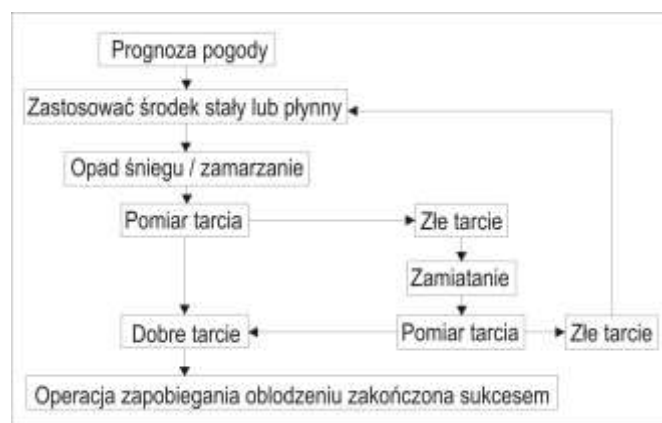
Rys. 2. Schemat zapobiegania oblodzeniu przy użyciu środków chemicznych
