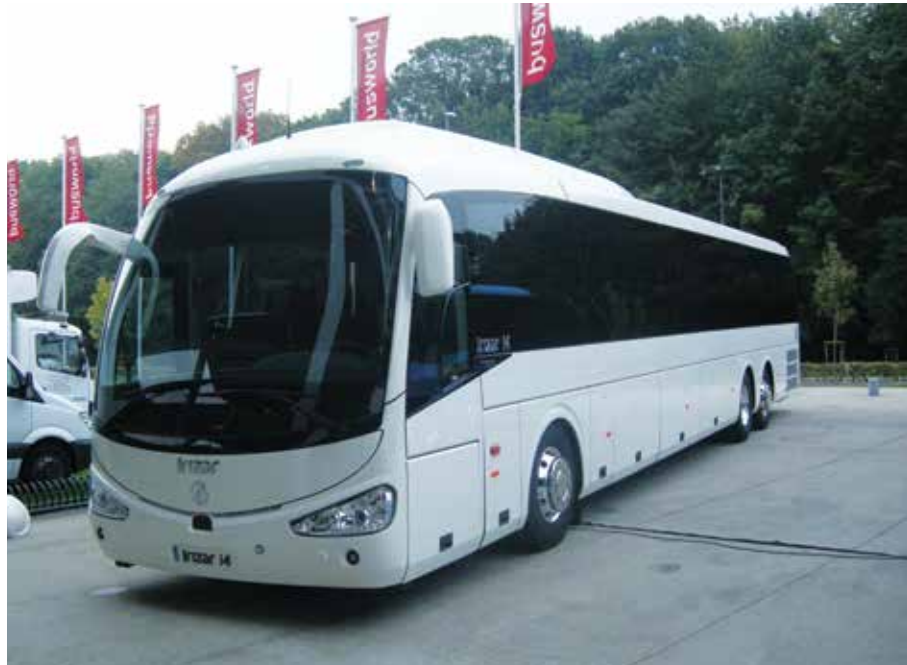
Trzyosiowa wersja i4L o długości 15 m z drzwiami w układzie 1-2-0
