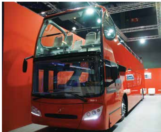
Wycieczkowy autobus Unvi Urbis z całkowicie przeszkloną ścianą przednią górnego pokładu
