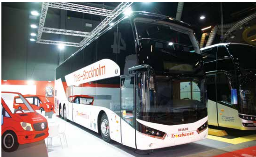
Piętrowy Unvi Sil z nadwoziem o wysokości 4,2 m
