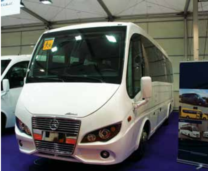
Midibus Ferqui F5 na podwoziu Mercedes Atego 1224L, przystosowany do przewozu 37 pasażerów
