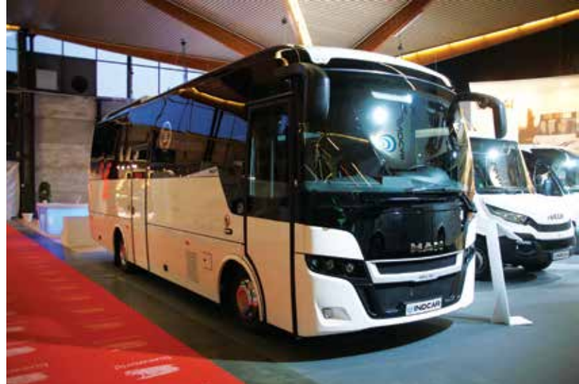
Indcar Next L9 na podwoziu MAN. Dostępna jest także wersja na podwoziu Mercedes Atego
