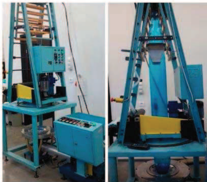
Rys. 1. Wygląd linii technologicznej wytwarzania folii W 25/25, przedsiębiorstwa „Metalchem” Toruń Fig. 1. View of blow molding technological line W 25/25, made by company „Metalchem” Toruń
