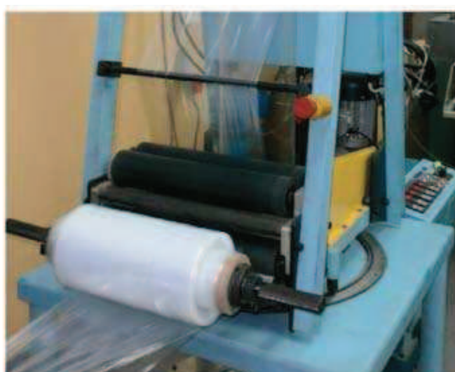
Rys. 2. Wygląd urządzenie odbierającego oraz urządzenia nawijającego linii technologicznej wraz z wytwarzanym rękawem folii Fig. 2. View of the receiving device and the winding device with sleeves produced films
