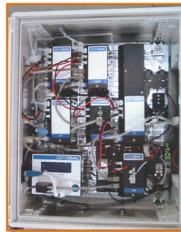
Rys. 6. Wnętrze mobilnej stacji jakości powietrza AEROQUAL
