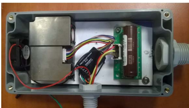
Rys. 4. Prototyp dodatkowego wyposażenia stacji pomiarowej
