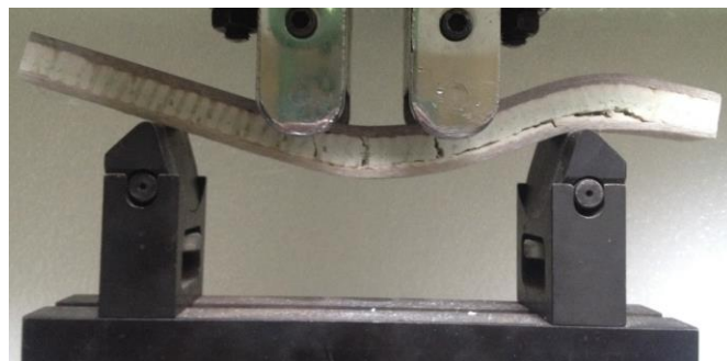
Rys. 3. Widok złomu próbki z przekładką Sphercore po próbie statycznego zginania
