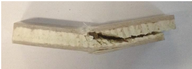
Rys. 6. Złom próbki z przekładką Sphercore po badaniu udarności
