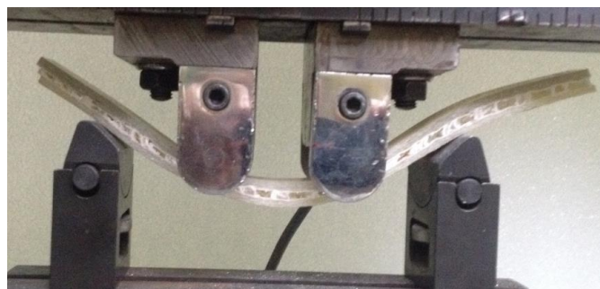
Rys. 2. Wygięcie próbki z przekładką Nidaplast
