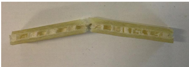
Rys. 7. Złom próbki z przekładką Nidaplast po badaniu udarności
