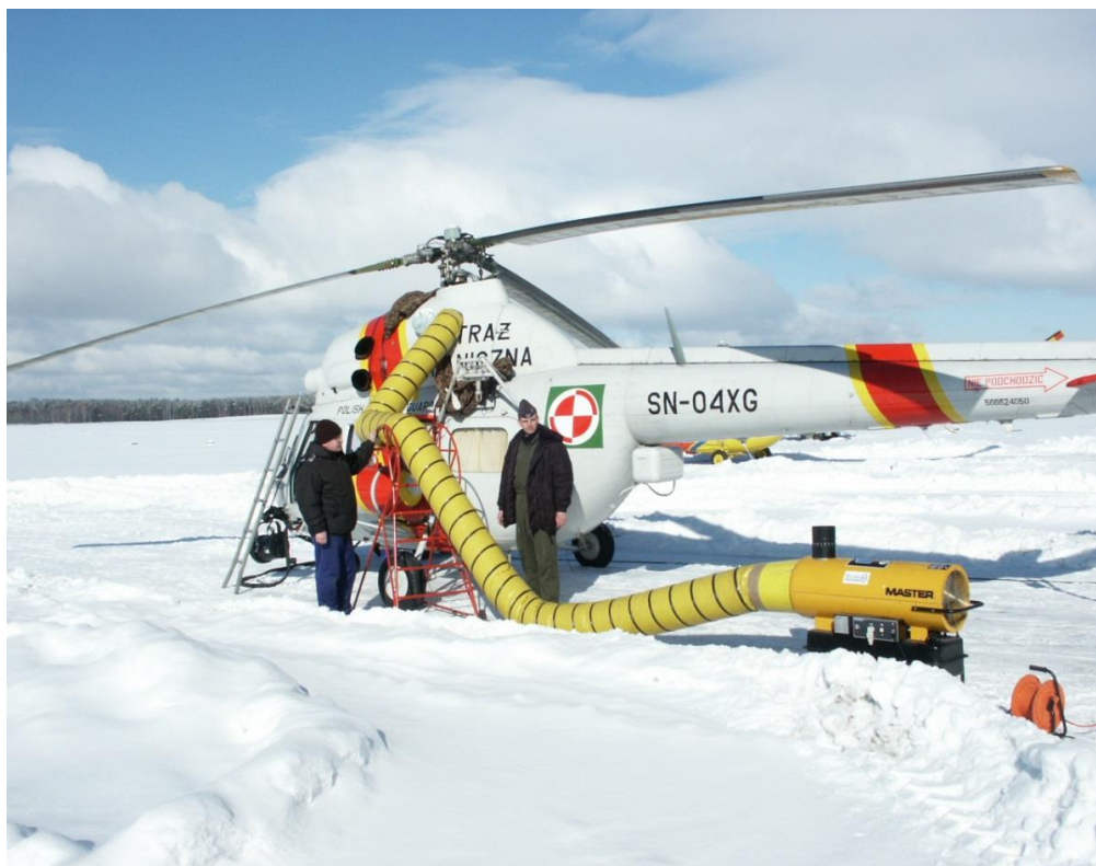
Rys. 1. Podgrzewanie przedziału przekładni głównej śmigłowca PZL-KANIA z użyciem pieca podgrzewczego
