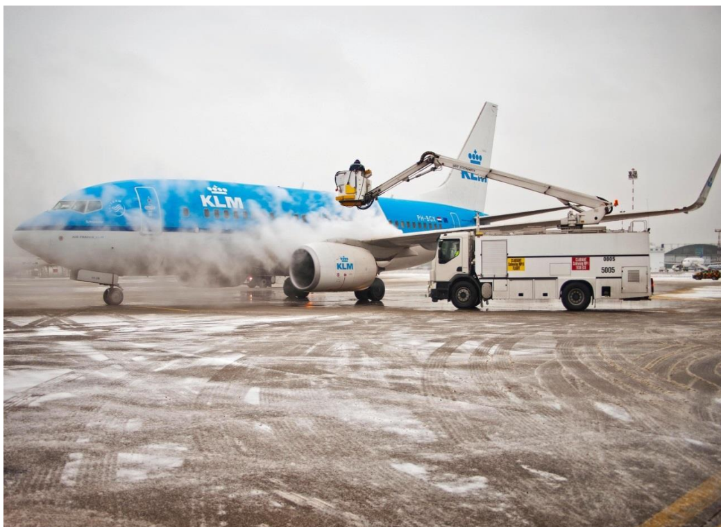
Rys. 2. Odladzanie samolotu za pomocą pojazdu specjalnego z wysięgnikiem operatora w odkrytej kabinie
