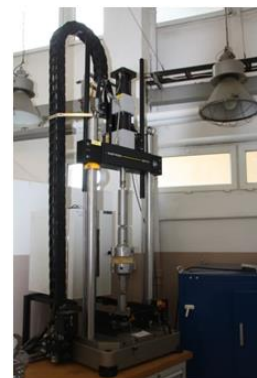
Rys. 1. Maszyna wytrzymałościowa statyczno-dynamiczna typu Instron 8872
