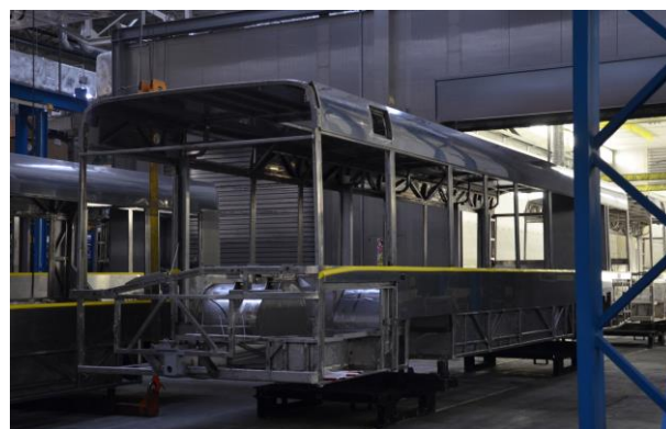
Rys. 2. Szkielet trolejbusu Solaris Trollino 12MB
