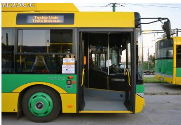
Rys. 1. Odizolowany pierwszy stopień drzwi wejściowych
