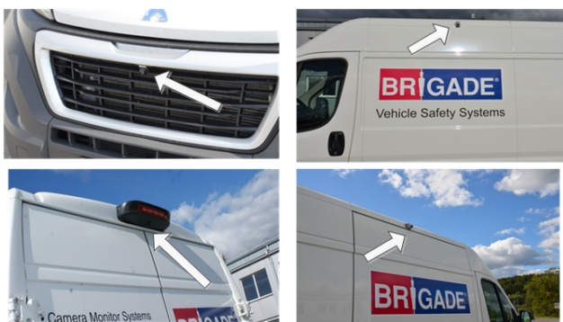
Rys. 6. Przykładowy sposób zamontowania kamer na pojeździe typu furgon
