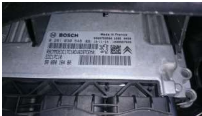
Rys. 13 Sterownik silnika w samochodzie Peugeot Partner Tapee
