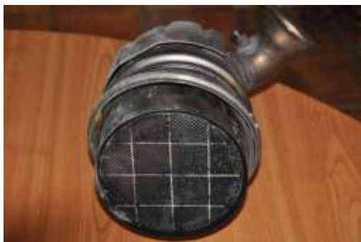
Rys. 1. Filtr cząstek stałych zdemontowany z pojazdu o przebiegu około 3000 km
