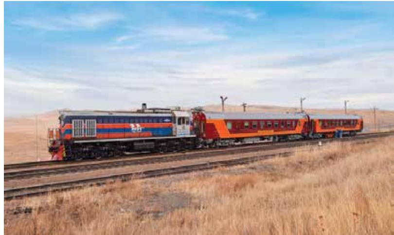
Wagony do kontroli stanu infrastruktury Dekart nr 229 i WD-UMT-1 nr 176M prowadzone lokomotywą serii TEM18DM-3021 na stacji Chooht (13.10.2014 r.)
