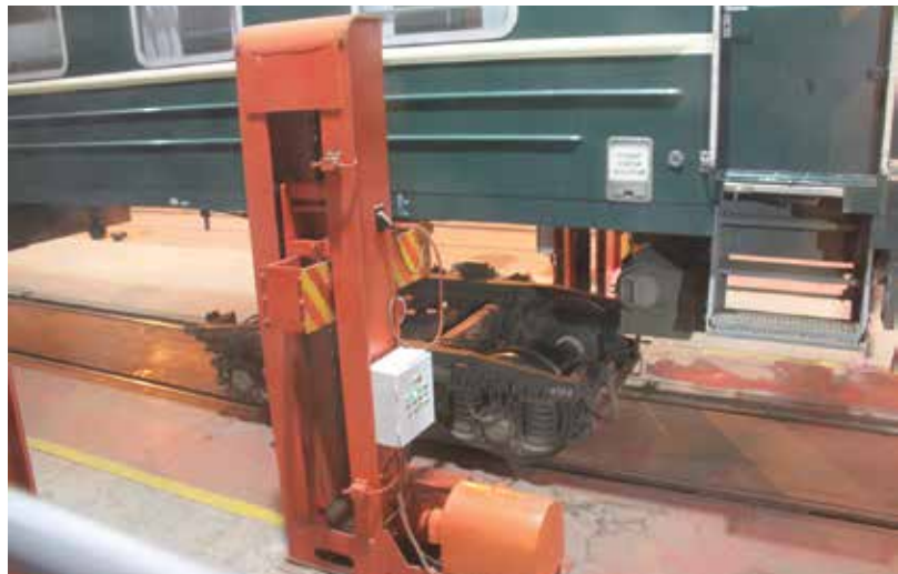
Operacja konwencjonalnej wymiany wózków na podnośnika Kutruffa na stacji granicznej CR Erenhot, Chiny (10.08.2013 r.) fot. D. Wannyn
