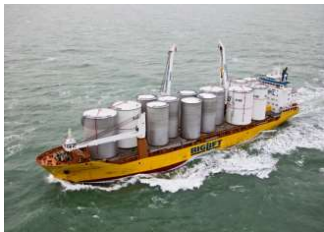
Rys. 1. Typowy specjalistyczny statek do przewozu ładunków wielkogabarytowych typu Happy R-type firmy Big_Lift z załadowanymi na pokładzie otwartym wielkimi zbiornikami stalowymi Źródło: Big Lift . com [4]
