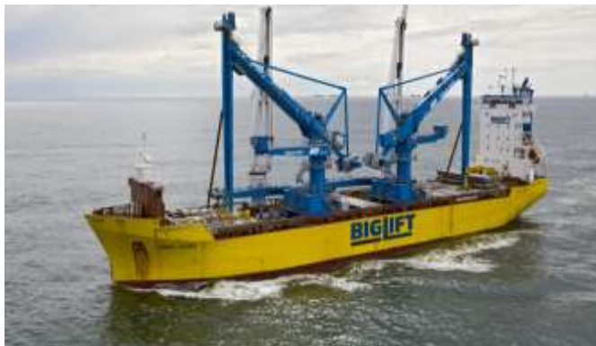
Rys. 7. Siostrzany w stosunku do opisywanego w artykule m/s Happy Ranger ciężarowiec klasy R-type m/s Happy River z załadowanymi na pokładzie otwartym wielkimi żurawiami portowymi do przeładunku ładunków sykich i zboża Źródło: Big Lift . com [4]
