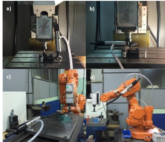
Rys. 5. Konfiguracje sposobu umieszczenia systemu chłodzenia w strefie obróbki [5]
