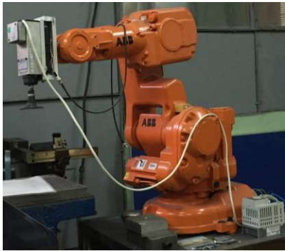
Rys. 3. Testy systemu chłodzenia realizowano na robocie przemysłowym firmy ABB, który wyposażony został w aktywną głowicę obróbkową przeznaczoną do obróbki ścierniej [5]
