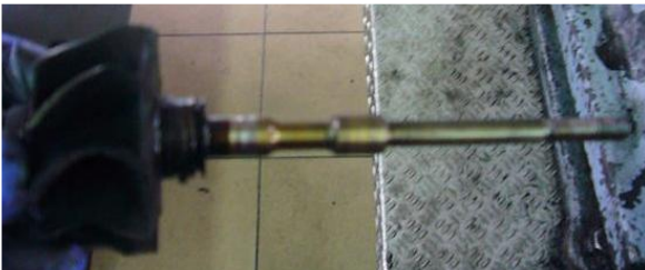
Rys. 2. Uszkodzenie wałka turbosprężarki Garrett z silnika 1.9 DCI samochodu Renault Laguna spowodowane nadmiernym tarcem
