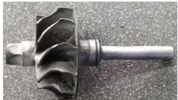
Rys. 6. Złamany wałek wraz z wirnikiem turbiny
