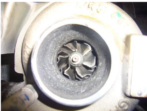
Rys. 3. Uszkodzony wirnik sprężarki w turbosprężarce Garrett z silnika Perkins
