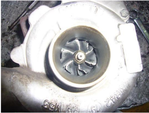
Rys. 1. Uszkodzony wirnik sprężarki w turbosprężarce Garrett z silnika 1.9 DCI samochodu Renault Laguna
