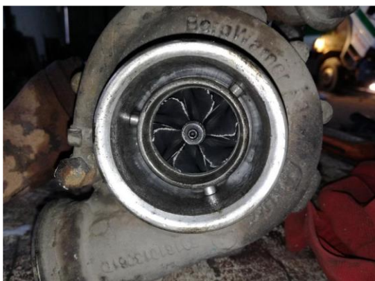
Rys. 8. Uszkodzenie wirnika sprężarki Borg Warner pochodzącej z samochodu ciężarowego Mercedes Atego spowodowane przez ciała obce
