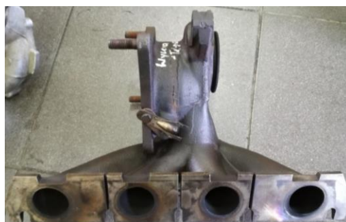
Rys. 12. Uszkodzenie korpusu żeliwnego turbosprężarki Borg Warner połączonego z kolektorem wydechowym, pochodzącej z silnika 2.0 TFSI
