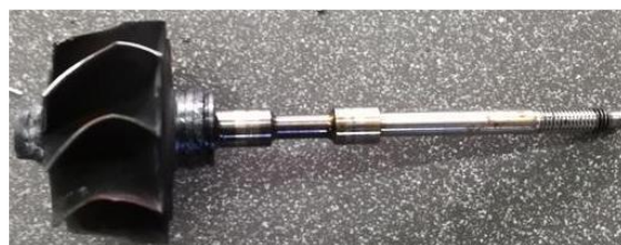
Rys. 11. Uszkodzony wałek turbosprężarki na skutek zanieczyszczenia oleju
