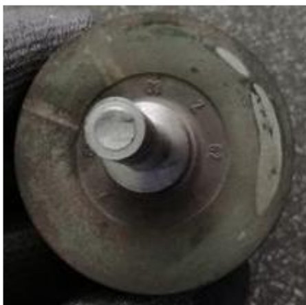
Rys. 7. Złamanie wałka turbosprężarki widoczne od czola
