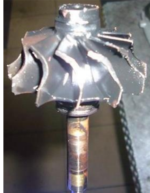
Rys. 5. Uszkodzony wirnik turbiny turbosprężarki Garrett z silnika Perkins
