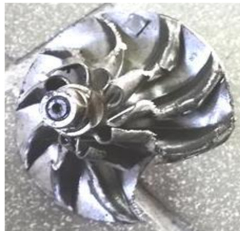
Rys. 10. Uszkodzony wirnik sprężarki na skutek zbyt wysokiej prędkości obrotowej
