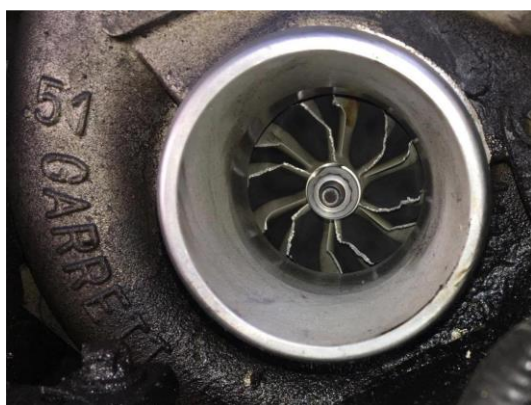
Rys. 9. Uszkodzenie wirnika sprężarki Garrett w samochodzie Mercedes-Benz ML 320 CDI spowodowane zbyt rzadką wymianą filtrów powietrza
