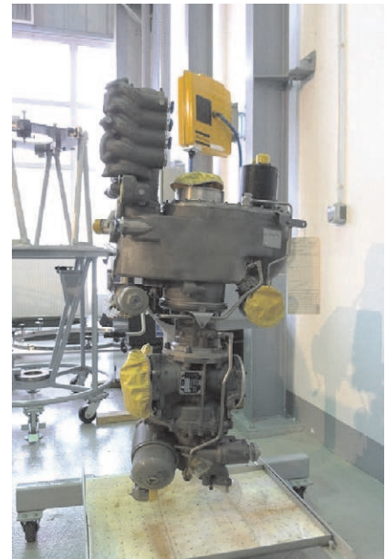
Fig. 6. Module of generator drive box (in vertical position) Rys. 6. Moduł skrzynki napędu agregatów (w pozycji pionowej)
