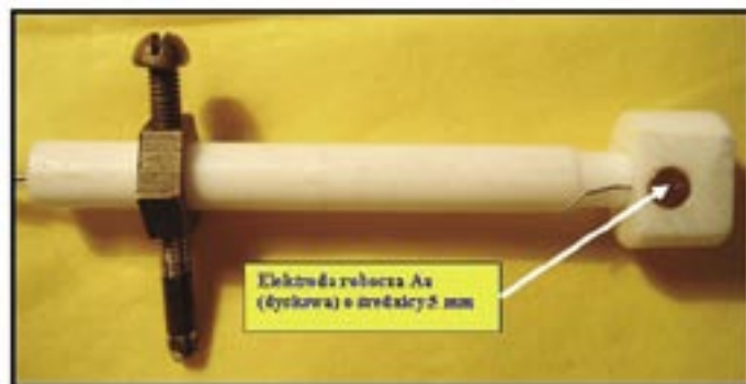
Rys. 5. Głowica obrotowa z roboczą elektrodą złotą, dyskową
