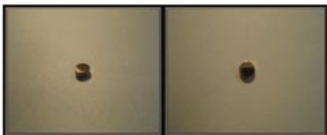
Rys. 2. Elektroda robocza, złota, dyskowa o średnicy 5mm, grubości 3mm i powierzchni 0,1cm 2
