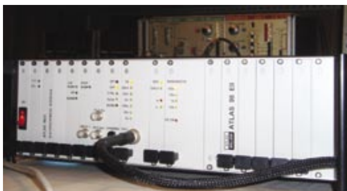
Rys. 3. Potencjostat - zestaw do badań elektrochemicznych ATLAS 99 [9933 ElectrochemicalInterface, 9923 Frequency Response Analyser)
