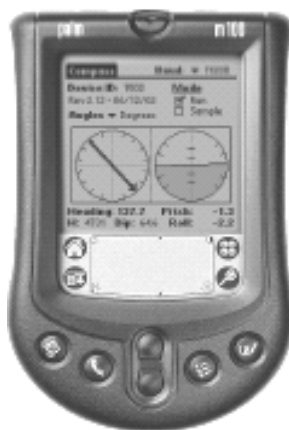
Rys. 2. Interfejs systemu rejestracji danych z kompasu TNT Fig. 2. User interface for TNT compass
