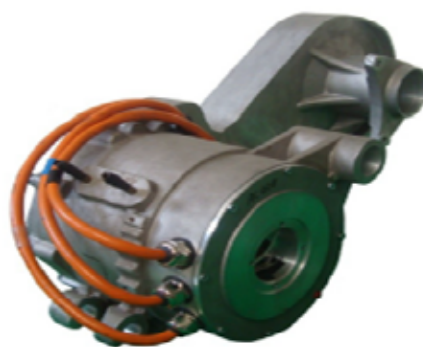
Rys. 4. Pojazd elektryczny Re-Volt firmy Impact Automotive Technologies i jego blok napędowy zespolony z tylną osią [3]
