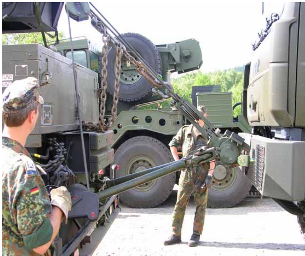
Rys. 5. Ewakuacja za pomocą żurawia i holu sztywnego za zderzak przedni
