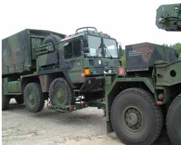
Rys. 4. Ewakuacja za pomocą wysięgnika hydraulicznego z adapterem dostosowanym do podjazdu pod przednią oś pojazdu holowanego oraz pasów spinających przednie koła
