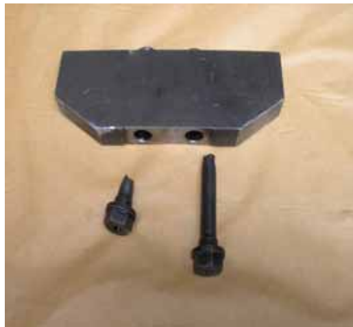
Rys. 15. Pęknięcie i zerwanie śrub przeciwcieżaru [1]
