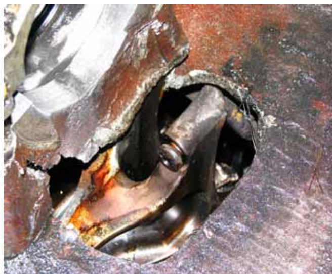
Rys. 12. Zniszczenie bloku silnika [1]
