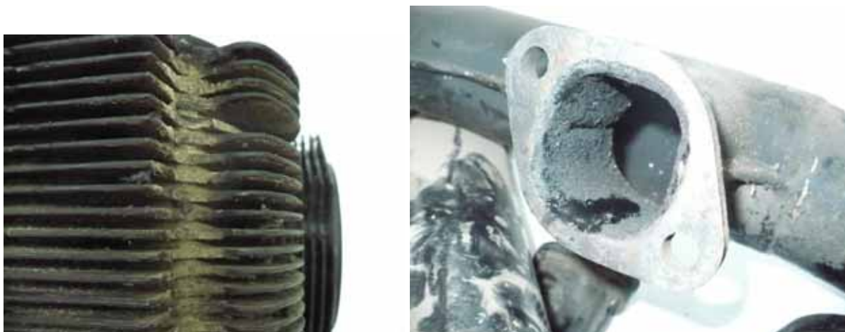
Rys. 6. Osad na łożyskach chłodzenia tulei oraz w kanale kolektora ssącego
