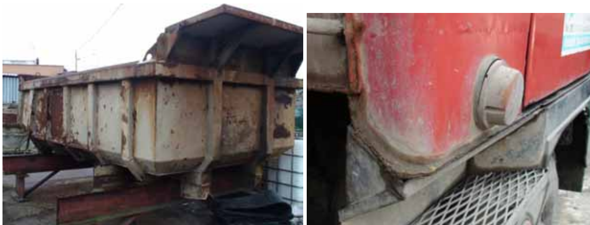
Rys. 5. Zużyta skrzynia ładunkowa oraz korozja kabiny
