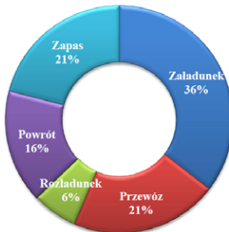
Rys. 3. Udział poszczególnych czynności transportowych w czasie trwania jednego kursu – ruch trzech pojazdów
