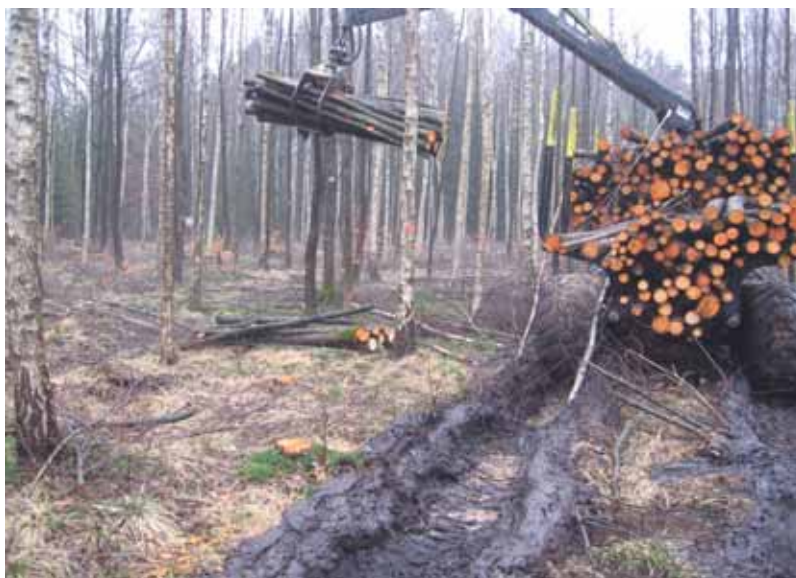
Rys. 2. Załadunek drewna małowymiarowego na wózek forwardera Źródło: Fot. Ł. Lewaszkiewicz.
