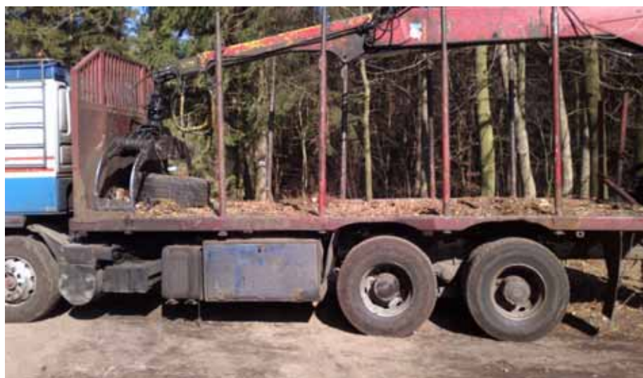
Rys. 5. Specjalistyczny samochód wyposażony w hydrauliczny dźwignik wysięgnikowy umożliwiający załadunek, przewóz i rozładunek drewna
