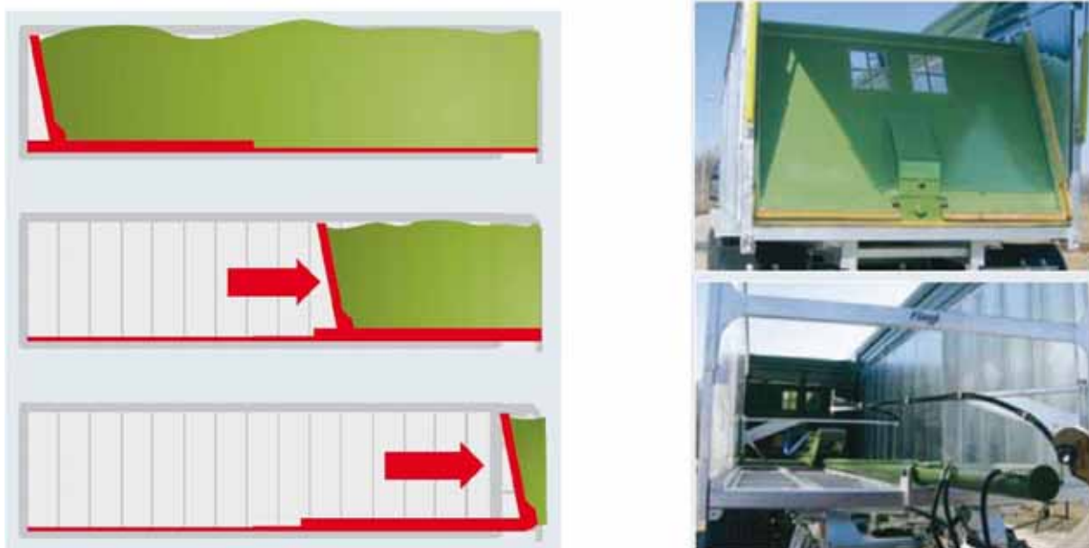
Rys. 4. System wyładunku i zagęszczania Gigant w przyczepach objętościowych Fliegl [5]
