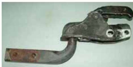
Fot. 2. Hak wybudowany z samochodu, który był sprzęgnięty z przyczepą oraz zaczep wybudowany z przyczepy holowanej w chwili zaistnienia wypadku
