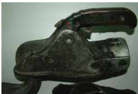
Fot. 6. Zaczep przyczepy z hakiem obrazujący stopień zużycia zaczepu według wskaźnika usytuowanego na obudowie
