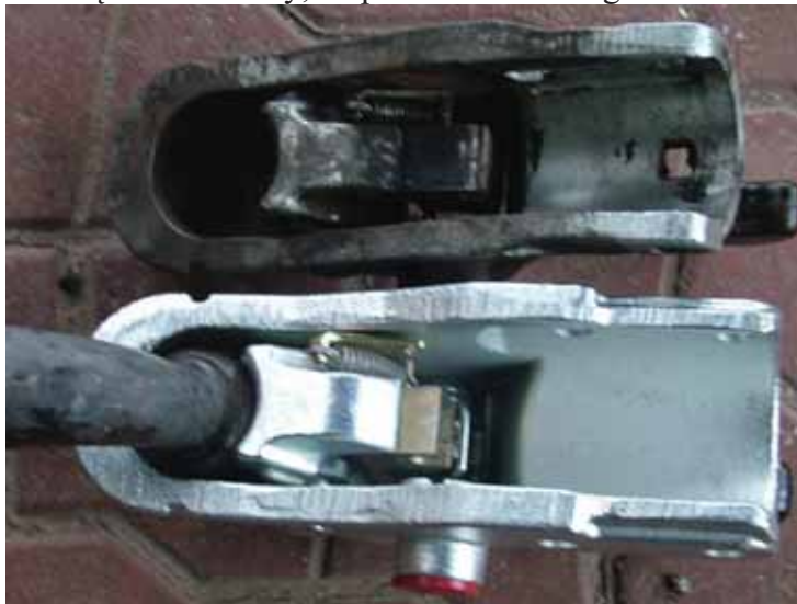
Fot. 1. Zaczep zabudowany na przyczepie nosił cechy znacznego zużycia ściernego we wnętrzu obudowy
