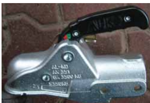
Fot. 7. Po zabudowaniu zaczepu nowego na hak z samochodu ciągnącego wskaźnik zużycia został przemieszczony na pole zielone
