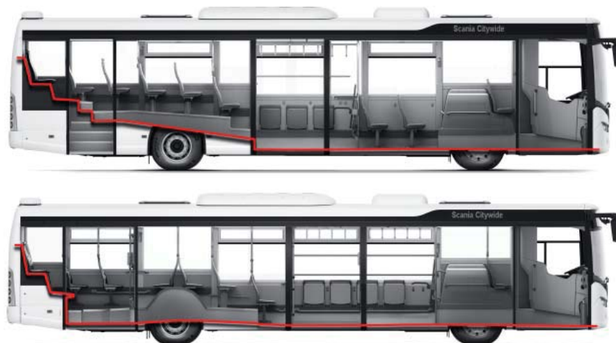
Różnice w budowie nadwozia autobusu Citywide w wersji LF (niskopodłogowej) i LE (niskowejściowej)
