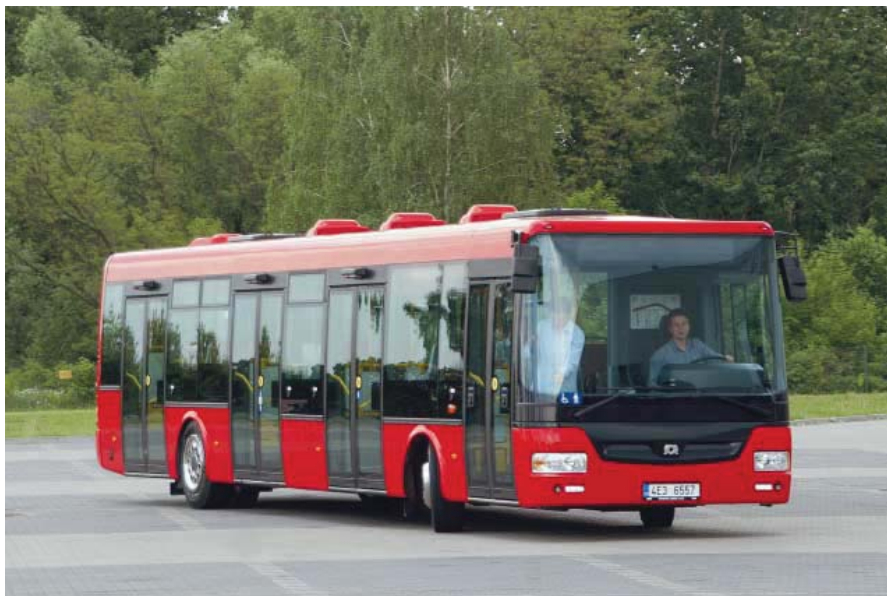
Niskopodłogowy autobus NB12 z nietypowym układem drzwi 2-2/2-2
