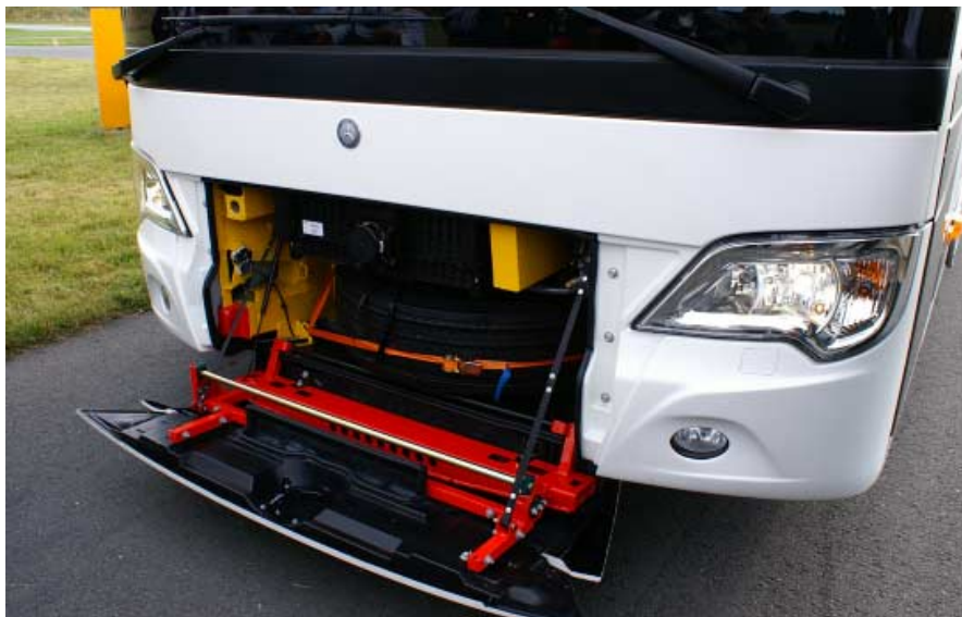
Radar systemu ABA umieszczony pod przednią atrapą
