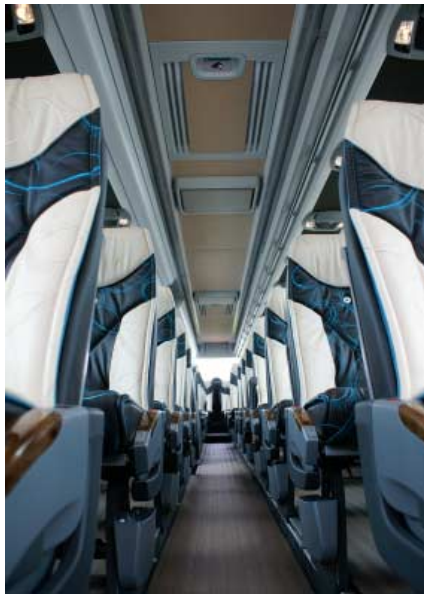
Przestrzenne wnętrze autobusu z środkowym przejściem o wysokości 2,10 m z widocznymi trzema składanymi monitorami o przekątnej 19"
