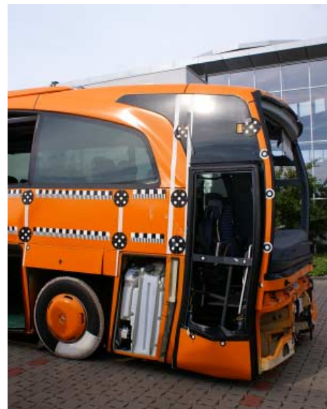
Mercedes Travego po próbach zniszczeniowych, których celem był m.in test systemu FCG
