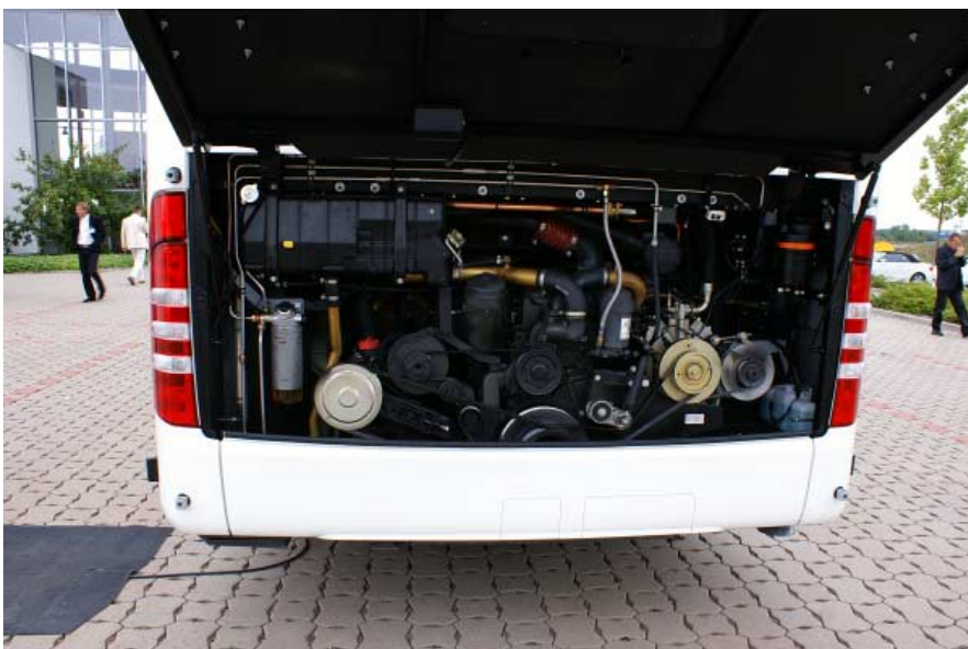
Fot. 11. Standardowe źródło napędu stanowi dwunastolitrowy silnik OM457 LA
