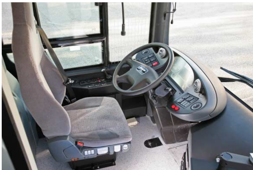
Fot. 14. Charakterystyczny elipsoidalny kokpit opracowany przez inżynierów z MAN, wykorzystuje elementy ciężarówki TGA.
