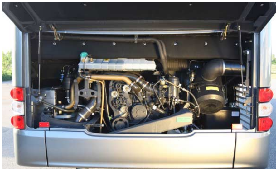
Fot. 15. Wnętrze komory silnika z leżącym silnikiem common-rail MAN D2066
