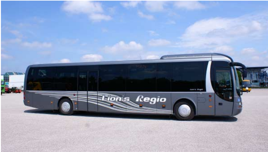
Struktura przestrzenna Lion's Regio nie wymaga stosowania bocznego poszycia z metalu
