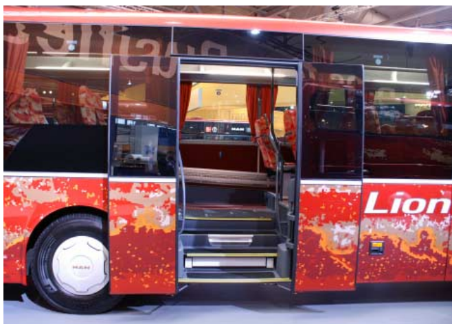
Fot. 9. Środkowe dwuskrzydłowe drzwi z windą dla wózków inwalidzkich zamontowaną pod drugim stopniem
