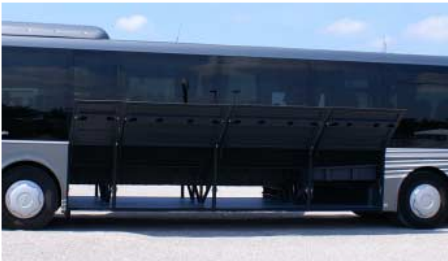
Dostęp do przestrzeni bagażowej możliwy jest po otwarciu jednej z czterech klap, blokowanych centralnym zamkiem
