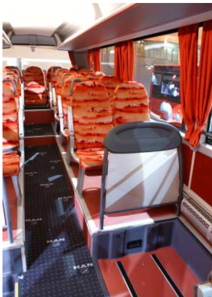
Likwidacja podestu pozwala na wygospodarowanie przestrzeni do zamocowania jednego wózka inwalidzkiego lub dodatkowego miejsca dla siedmiu stojących pasażerów
