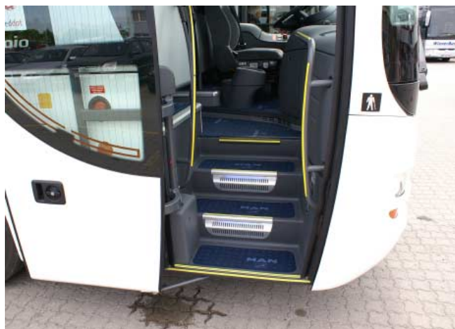
Fot. 10. Przednie drzwi z włączonym podświetleniem stopni
