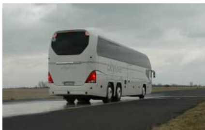
Fot. 6. NEOPLAN Cityliner podczas próby hamowania na śliskiej nawierzchni
