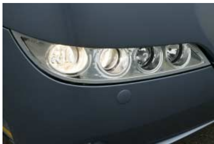
Fot. 1e. Światła zmieniające kierunek strumienia wraz ze skrętem kół (fot. NeoMAN)
