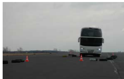
Próba działania systemu ESP podczas gwałtownych manewrów omijania przeszkody
