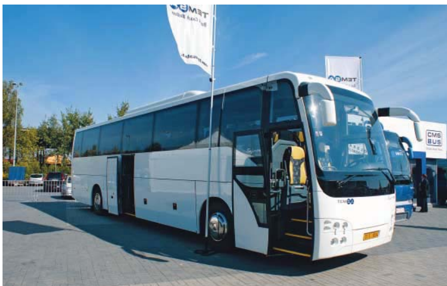
Autobus turystyczny TEMSA Safari HD z nadwoziem ze stali nierdzewnej i komponentami DAF i ZF
