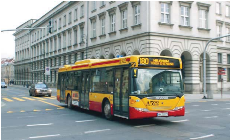
Scania OmniCity należąca do PKS Grodzisk Wlkp. z silnikiem Euro-4 w technologii EGR
