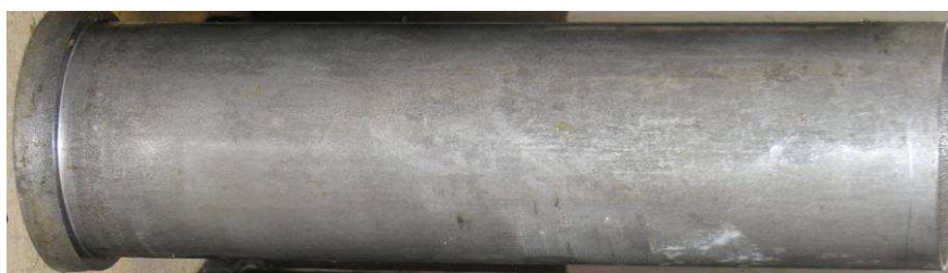
Rys. 3. Łuska kalibru 30 mm po operacji prasowania dna Fig. 3. 30 mm cartridge case after operation of cartridge base pressing
