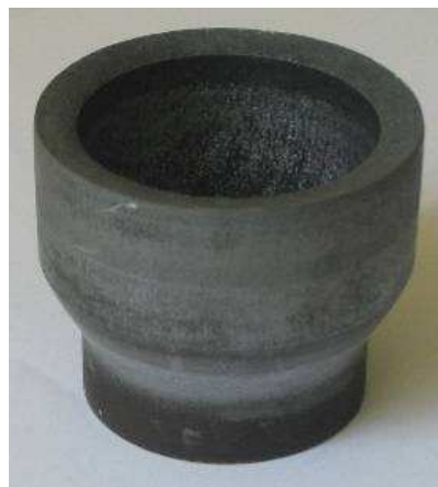
Rys. 1. Wypraska łuski kalibru 30 mm po operacji wyciskania przeciwbieżnego Fig. 1. Die stamping of 30 mm cartridge case after operation of indirect extrusion
