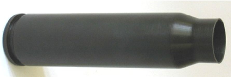
Rys. 4. Łuska kalibru 30 mm po obróbce plastycznej oraz po obróbce skrawaniem
