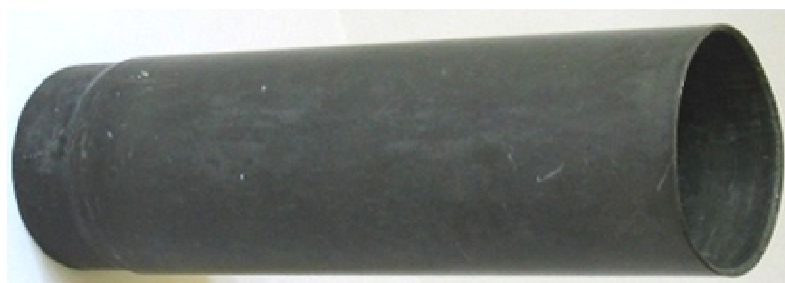
Rys. 2. Łuska kalibru 30 mm po trzeciej operacji wyciągania ścianki Fig. 2. 30 mm cartridge case after third operation of wall drawing
