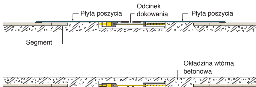
Rys. 19. Łączenie urządzeń tarczowych przez wprowadzenie pierścienia penetrującego do komory przyjmującej [8]
