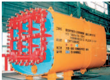
Rys. 17. Urządzenie DPLEX zastosowane do budowy kolektora kanalizacyjnego Kikutagawa w Narashino [3]
