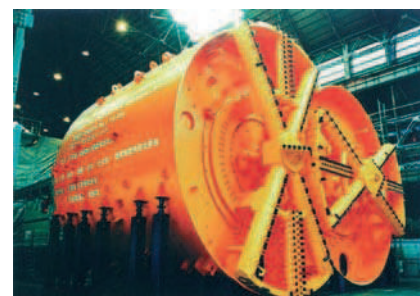
Rys. 2. Urządzenie DOT wykorzystane do budowy tunelu w dzielnicy Ariake – kita w obszarze metropolii Tokio [2]
