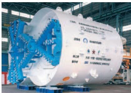
Rys. 3. Urządzenie DOT wykorzystane do budowy odcinka Chayagasaka miejskiej linii metra w Nagoi [2]
