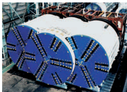
Rys. 11. Urządzenie do tunelowania metodą tarczy wielokołowej składające się z trzech segmentów [7]
