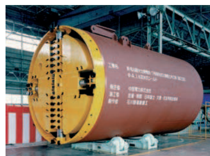
Rys. 22. Urządzenia użyte do budowy gazociągu dla nowej elektrociepłowni w Nagoi (urządzenie napierające z wysuniętym pierścieniem pokazano po lewej stronie, a urządzenie przyjmujące po prawej stronie) [8]
