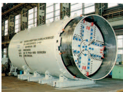
Rys. 22. Urządzenia użyte do budowy gazociągu dla nowej elektrociepłowni w Nagoi (urządzenie napierające z wysuniętym pierścieniem pokazano po lewej stronie, a urządzenie przyjmujące po prawej stronie) [8]
