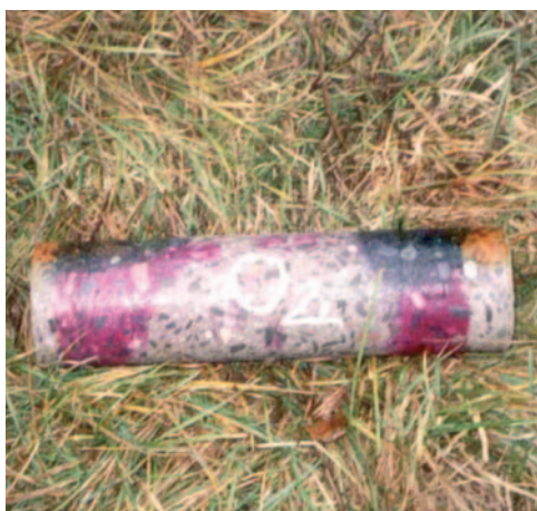
Fot. 6. Przykładowy wynik testu fenoloftaleinowego, przeprowadzonego na powierzchni odwiertu, pobranego z konstrukcji belki mostowej
