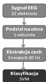
Rys. 2. Schemat przebiegu eksperymentu klasyfikacji sygnału EEG Fig. 2. Block diagram of classification process
