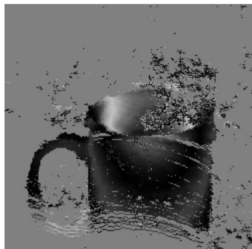
Rys. 2. Pojedynczy skan obiektu, zawierający błędy i braki Fig. 2. Single scan of an object, with errors and gaps
