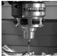
Rys. 3. Sonda przedmiotowa TS-640 Fig. 3. TS-640 workpiece touch probe
