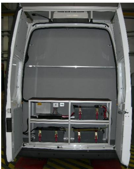
Rys. 7. Prototyp innowacyjnego mobilnego stanowiska dowodzenia zasilanego ogniwami fotowoltaicznymi, widok tylnej części pojazdu z zamontowanymi akumulatorami
