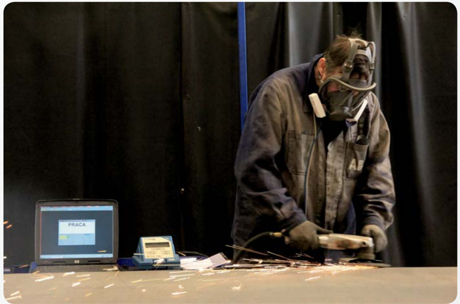
Fot. Wyznaczanie rzeczywistego wskaźnika ochrony z użyciem licznika cząstek PortaCount na stanowisku szlifierza konstrukcji stalowych dla maski skompletowanej z filtrami klasy P3
