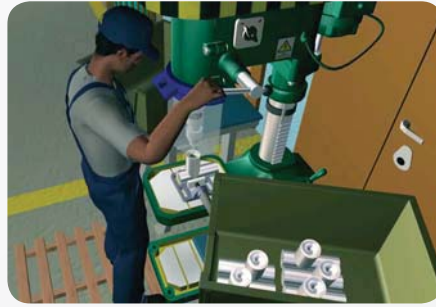
Fot.11. Komputerowo generowany widok sceny wykonania rozwiercania na wiertarce wyposażonej w imadło do mocowania przedmiotu i osłonę strefy roboczej wrzeciona Photo 11. Computer-generated view of a scene showing a ream made with a drill equipped with an object-holding-vice and a spindle's working space cover
