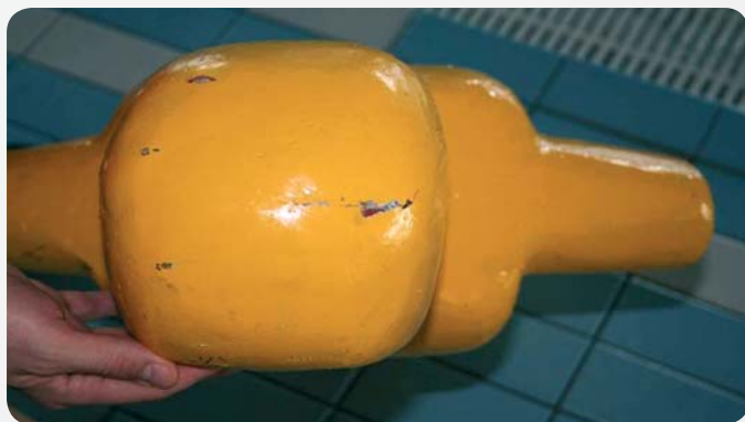
Fot. 7. Ślady uderzeń kołem ratunkowym w głowę manekina; trwałe uszkodzenia (pęknięcia) twardej powłoki Photo 7. Signs of impact to a manikin's head; permanent damage (cracks) of hard surface
